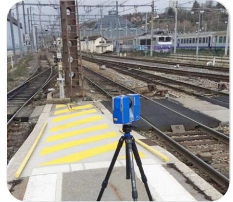
**Les données lasergrammétriques** acquises comportent tout ce qui est visible dans le champ de vision du capteur laser, et permettent donc une modélisation des objets TQC (Tels Que Construits). On parle également de "clone numérique".
